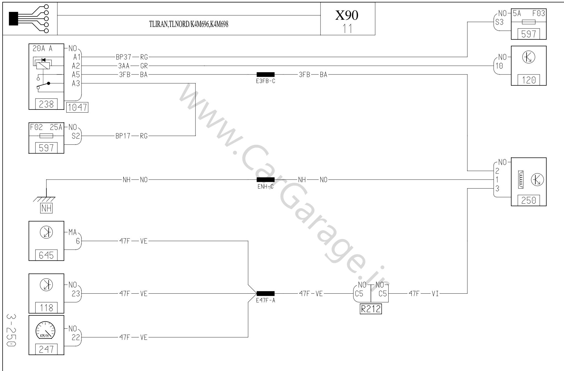
سیگنال سرعت خودرو دوگانه سوز [www.CarGarage.ir](http://www.CarGarage.ir)
